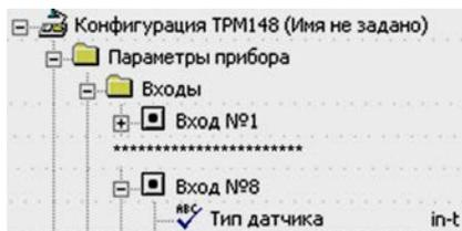
**ВНИМАНИЕ!** При неправильном задании значения параметра | **Тип датчика** | прибор будет производить некорректные измерения.
