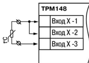
Рисунок Д.1 – Схема подключения термометра сопротивления
