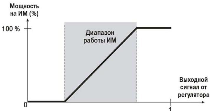
Рисунок 3.12 – Работа ИМ (тип «Нагреватель») в заданном диапазоне
