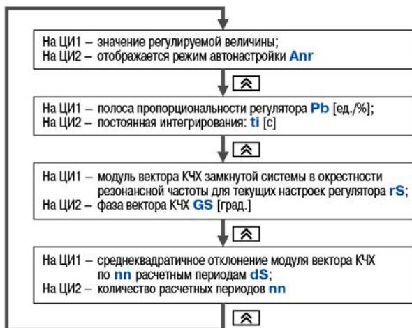
Рисунок 13.2 – Схема переключения индикации в режиме Автонастройки
