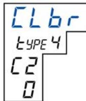
К.7 Пользователь должен нажать кнопку
