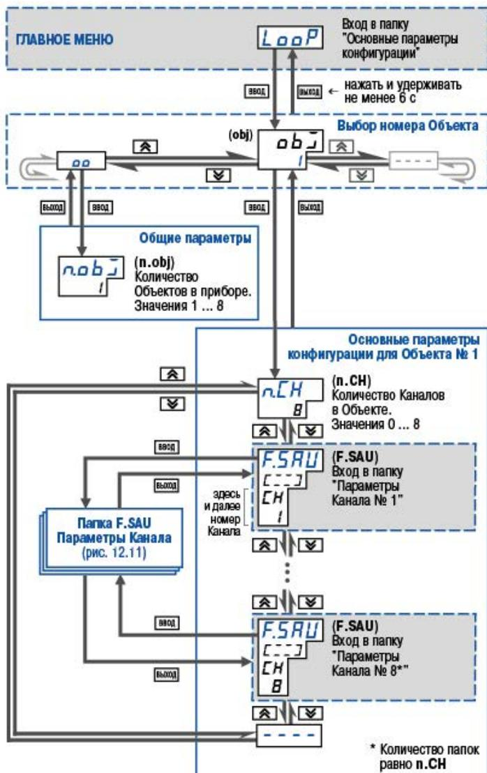
Рисунок 12.10 – Схема задания основных параметров конфигурации
