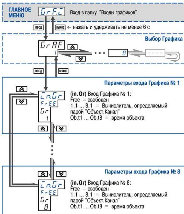
Рисунок 12.23 – Схема задания параметров входов графика
