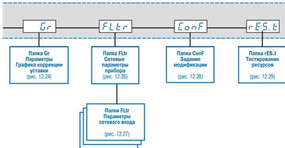
Рисунок 12.7 – Общая схема задания параметров прибора /продолжение/
