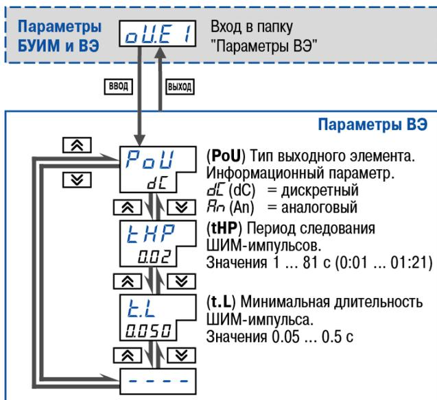
Рисунок 12.17 – Схема задания параметров Выходных элементов
