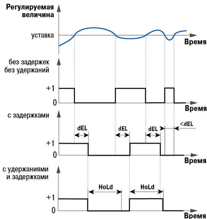
Рисунок 3.9 – Работа регулятора с заданными задержками и удержаниями
