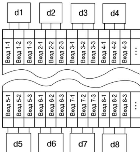
Рисунок Б.8 – Общая схема подключения измерительных датчиков
