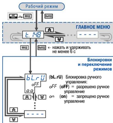
Рисунок 13.1 – Схема задания блокировок и переключения режимов
