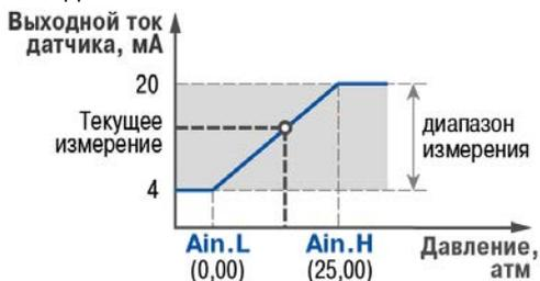
Рисунок 3.3 – Пример задания диапазона измерения активного датчика
