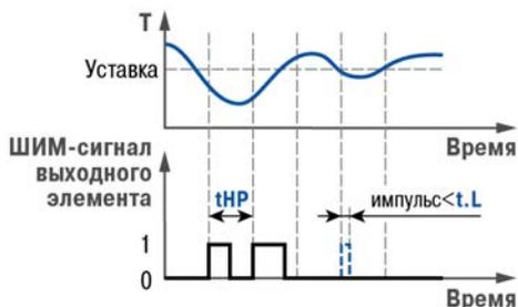
Рисунок 3.17 – Точность регулирования при разной частоте управляющих импульсов
