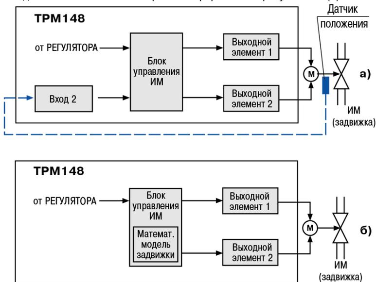
**Рисунок 3.11 – Управление 3-х позиционным ИМ:**
