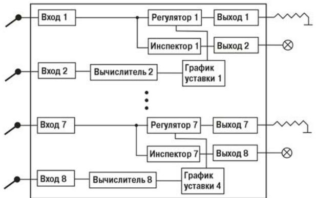
Рис. 4.11. Принципиальная схема модификации 5 прибора
