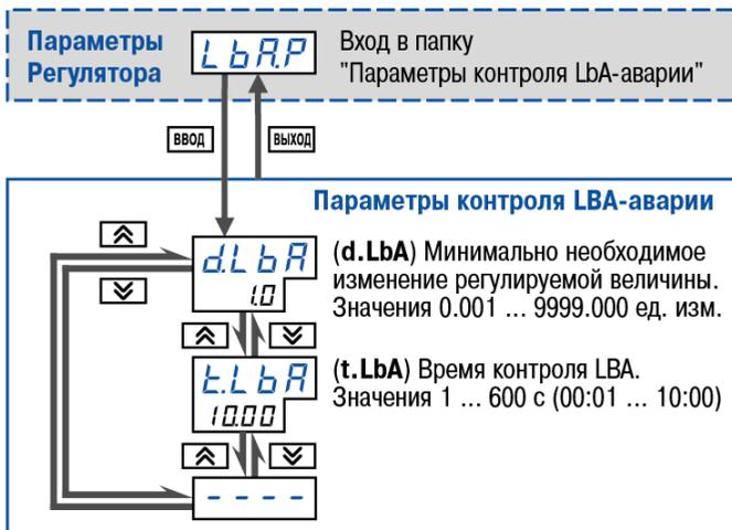
Рисунок 12.18 – Схема задания параметров контроля LbA-аварии
