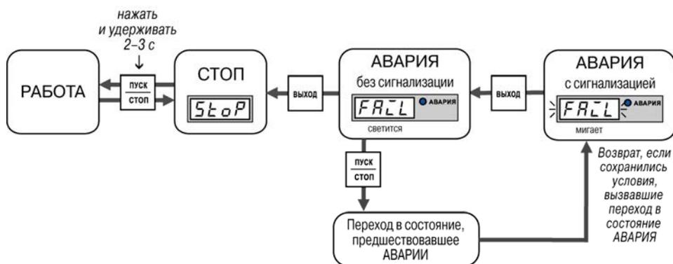
**Рисунок 6.2 – Схема переключения состояний прибора**
