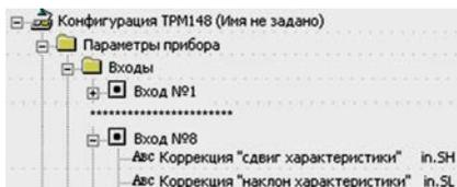
**Примечание** - При работе с платиновыми термометрами сопротивления на заданное в параметре **in.SH** значение сдвига накладывается также коррекция нелинейности НСХ датчика, заложенная в программе обработки результатов измерения.
