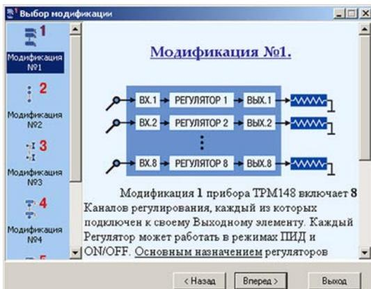
Рисунок 11.2 – Мастер выбора конфигураций. Окно выбора конфигураций прибора
