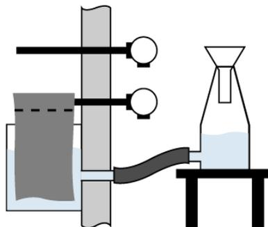
**Рисунок Л.4 – Конструкция резервуара для воды, не требующая вхождения в камеру**
