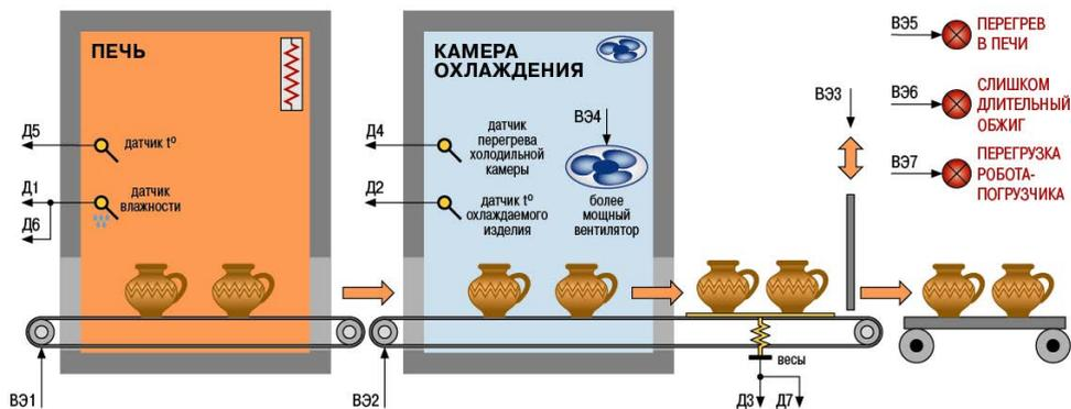
Рисунок 4.4 – Использование 8-канального регулятора ТРМ148 2-ой модификации в автоматизированном процессе обжига глиняных изделий
