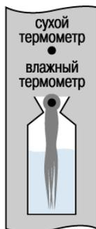
**Рисунок Л.3 – Форма резервуара с «бутылочным горлом»**
