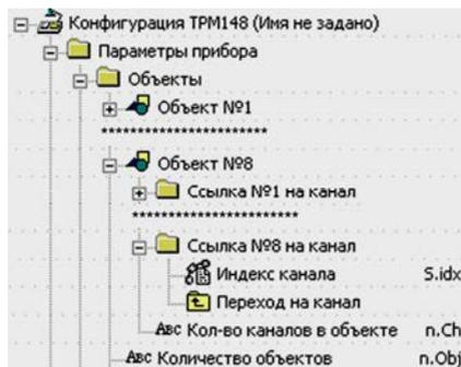
**Примечание** - При создании комбинации из нескольких объектов, объекты следует задавать строго по порядку, то есть не допускается подключение объектов в последовательности, например, 1, 2, 3, 5.
