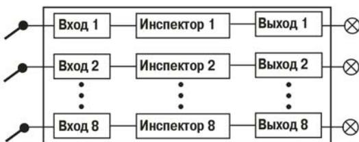
Рисунок 4.3 – Принципиальная схема модификации 2 прибора
