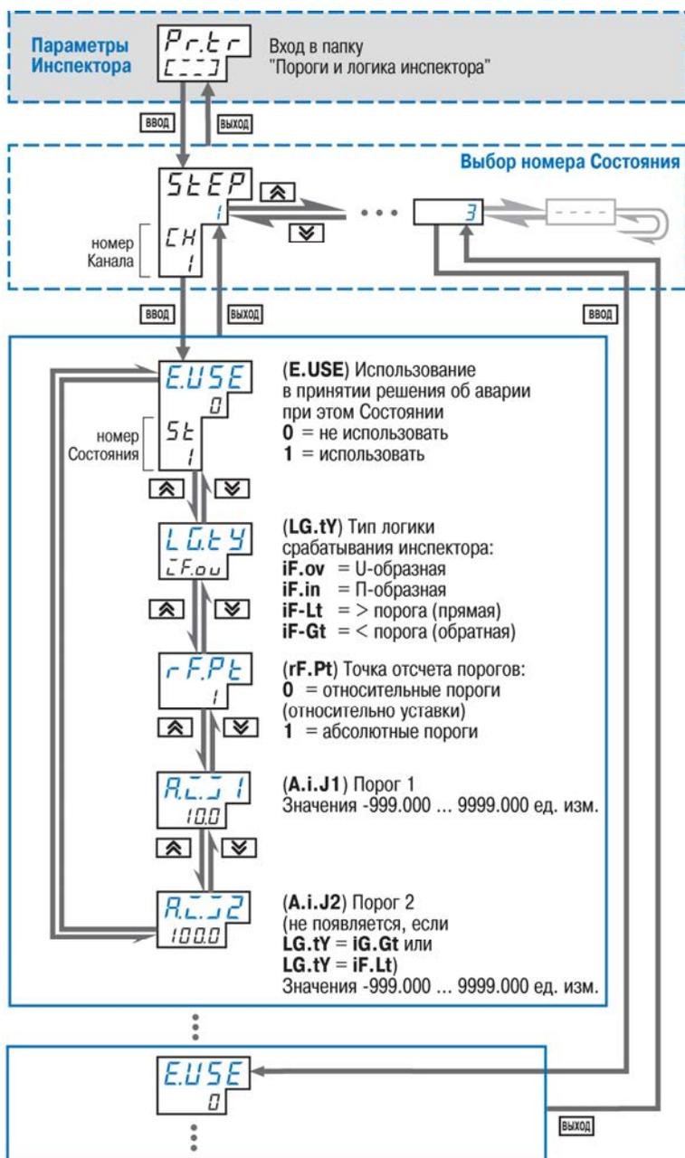
Рисунок 12.20 – Схема задания порогов и логики Инспектора
