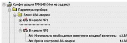
Режим контроля LBA-аварии можно включить или отключить в канале параметром **LbA**.
