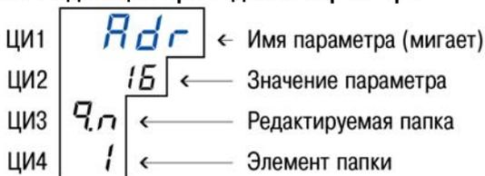
**Рисунок 12.3 – Показания цифровых индикаторов при задании параметров**
