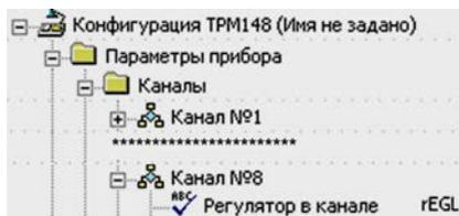
На вход Регулятора в приборе TPM148 подается значение с Вычислителя того же Канала (контролируемая величина) и Уставка. На выходе Регулятор вырабатывает сигнал, направленный на уменьшение отклонения контролируемой величины от Уставки. Допускается изменение Уставки в процессе выполнения программы, для этого существуют Графики коррекции Уставки. Выходной сигнал Регулятора поступает на Выходное устройство сложной структуры, с помощью которого осуществляется управление одним или несколькими ИМ.
