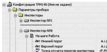
**Примечание** - Значение «относительно порогов» параметра **rF.Pt** в Инспекторе может быть установлено только в том случае, если в канале задействован регулятор и задана Уставка типа «значение».
