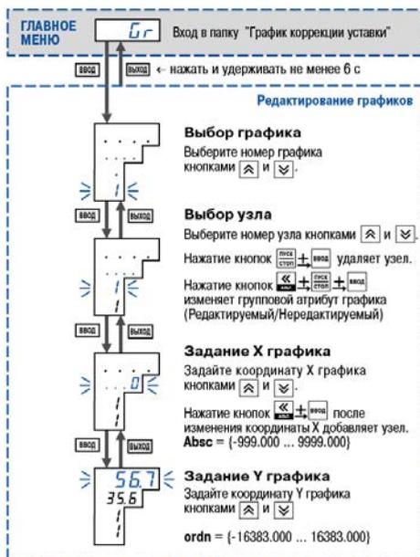
**Рисунок 12.24 – Задание и редактирование графика коррекции уставки**
