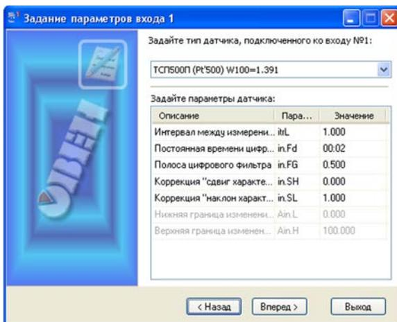
Рисунок 11.9 – Форма задания конфигурационных параметров модификации
