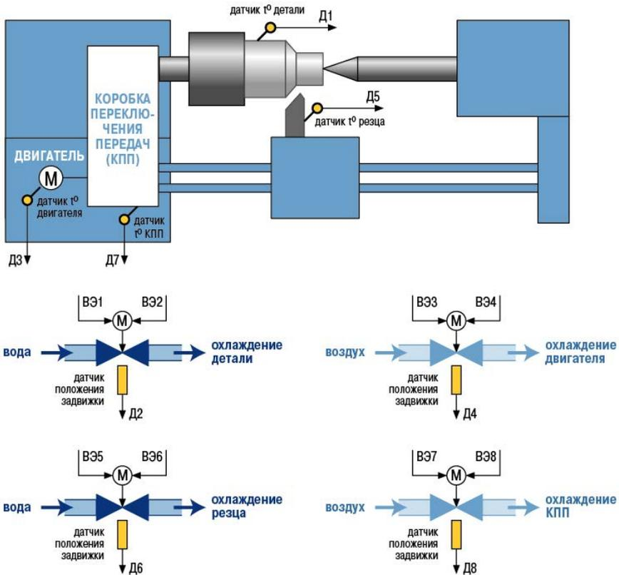
**Рисунок 4.7 – Использование 8-канального регулятора TRM148 3-ой модификации в технологической системе управления охлаждением станка для точной обработки деталей**
