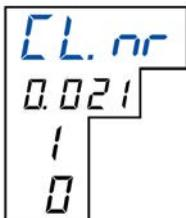
К.8 Для записи юстировочного коэффициента в память прибора пользователь нажимает кнопку **ВВОД**. После записи прибор выходит из меню юстировки и переходит в состояние, из которого юстировка была запущена.
