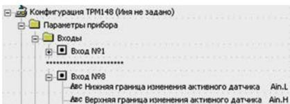
**Пример.** При использовании датчика с выходным током 4...20 мА, контролирующего давление в диапазоне 0...25 атм., в параметре **Ain.L** задается значение 00,00, а в параметре **Ain.H** – значение 25,00 (см. рисунок 3.3). После этого обработка и отображение показаний будет производиться в атмосферах.
