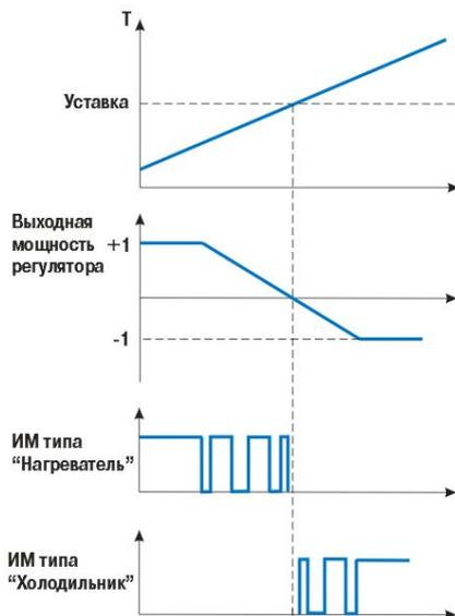
**Рисунок 3.5 – Принцип формирования ШИМ-сигнала для системы «нагреватель-холодильник»**
