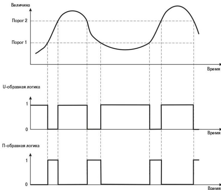
**Рисунок 3.19 – Работа Инспектора по U-образной и П-логикам**
