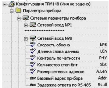
**ВНИМАНИЕ!** Прибор продолжает работать с прежними сетевыми настройками до тех пор, пока измененные значения параметров не будут записаны в прибор (см. п. 11.7.9). Измененные сетевые параметры помечаются зеленым шрифтом, а после их записи в прибор шрифт становится черным.
