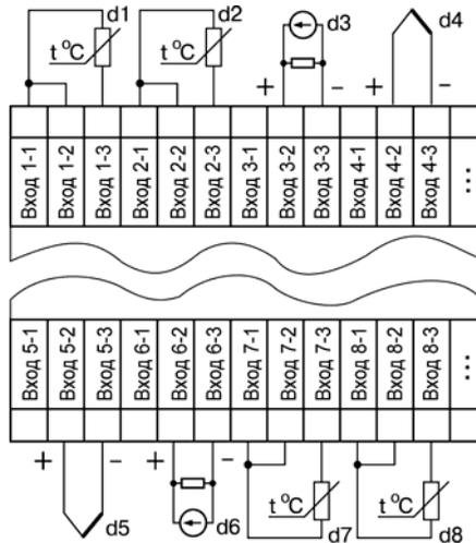
Рисунок Б.12 – Пример подключения датчиков различного типа
