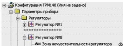
Зона нечувствительности используется при функционировании как ПИД-регулятора, так и Двухпозиционного регулятора.
