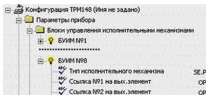
1. При подключении одного БУИМ к ПС, он работает во всем диапазоне выходного сигнала от регулятора (0...1 или -1...0, для нагревателя и холодильника, соответственно), как повторитель сигнала от ПС.
