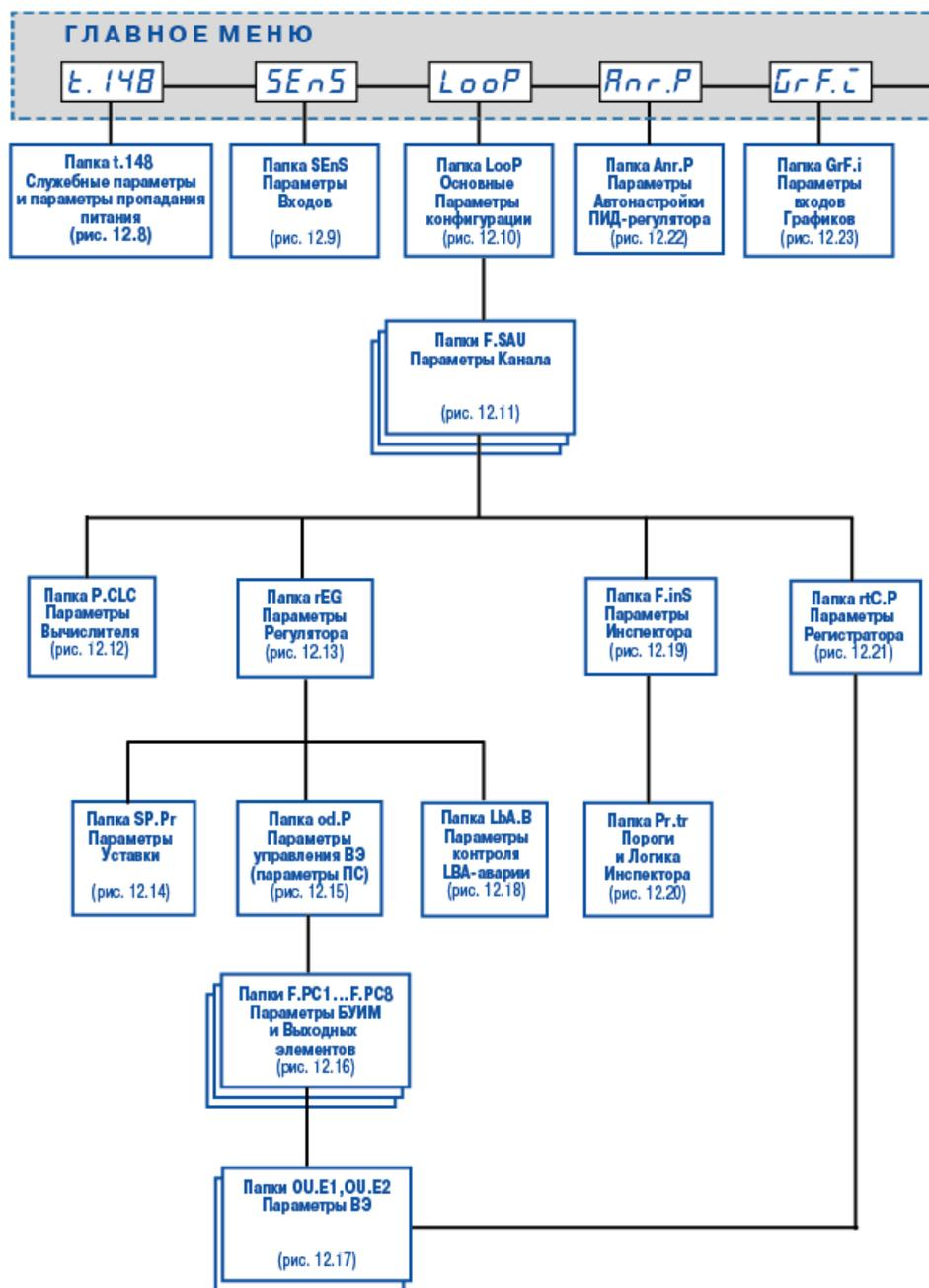
Рисунок 12.7 – Общая схема задания параметров прибора
