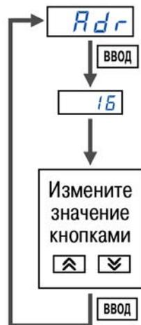
Рисунок 12.5 – Схема изменения значения параметра
