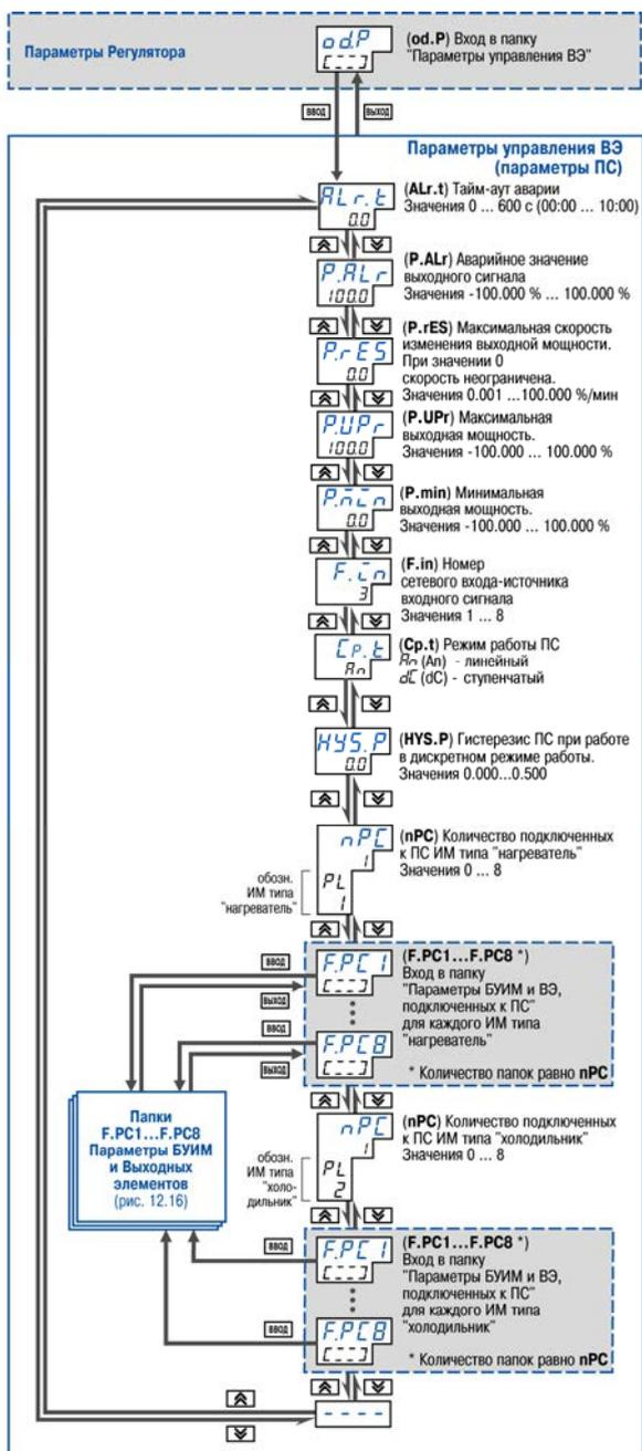
Рисунок 12.15 – Схема задания параметров управления РЭ
