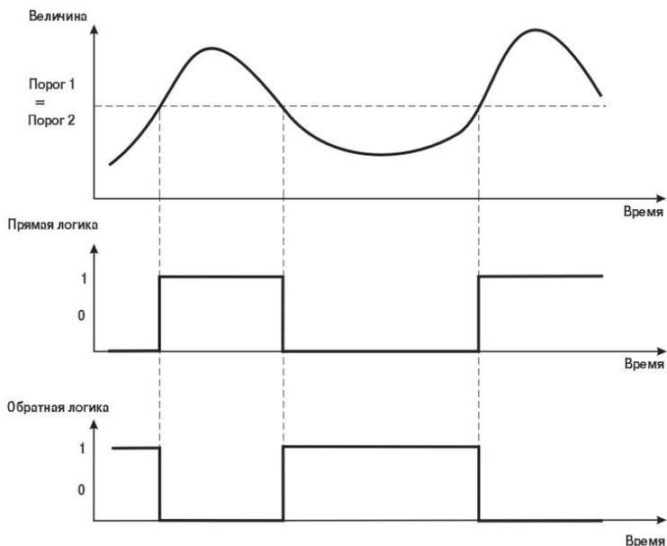
**Рисунок 3.20 – Работа Инспектора по прямой и обратной логикам**
