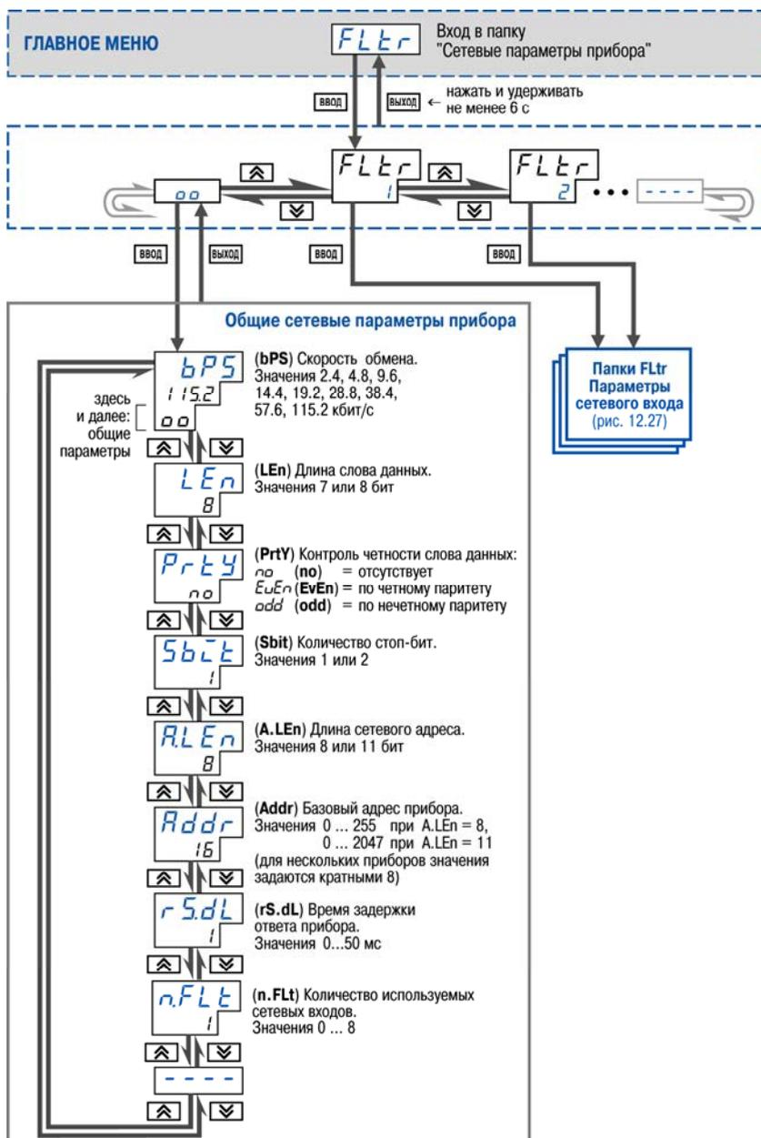
Рисунок 12.25 – Схема задания сетевых параметров прибора
