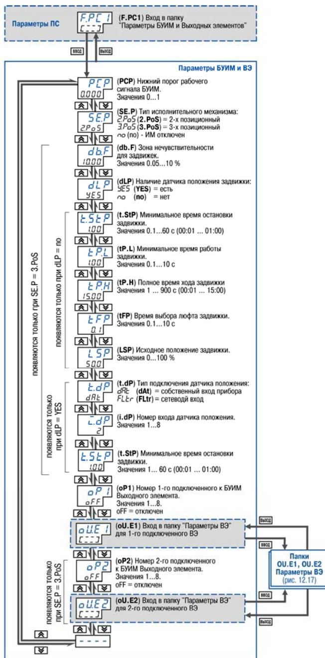
Рисунок 12.16 – Схема задания параметров БУИМ и Выходных элементов
