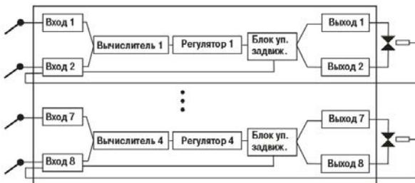
**Рисунок 4.5 – Принципиальная схема модификации 3 прибора**
